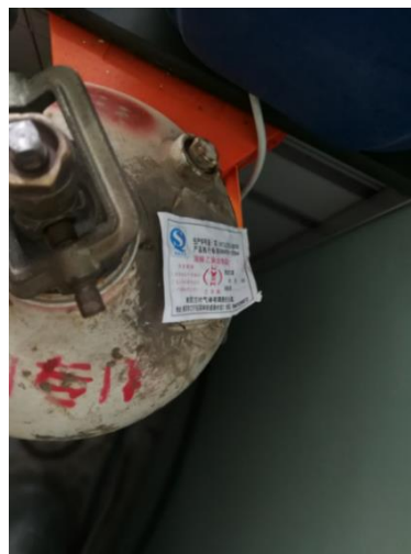
理科楼 A609—氧气气瓶和乙炔气瓶放在同一房间内，距离不超过 3 米，且氧气气瓶未固定
