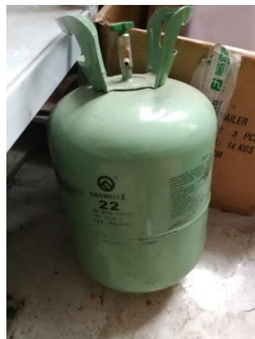
宁远车队—气瓶未固定，直接放置于地面
