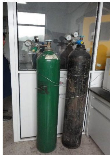
生科楼 C6010—公共仪器室内气瓶未固定
