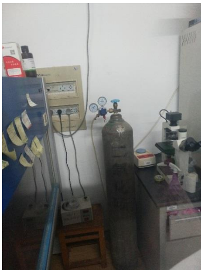
逸夫楼 1033—气瓶未固定
