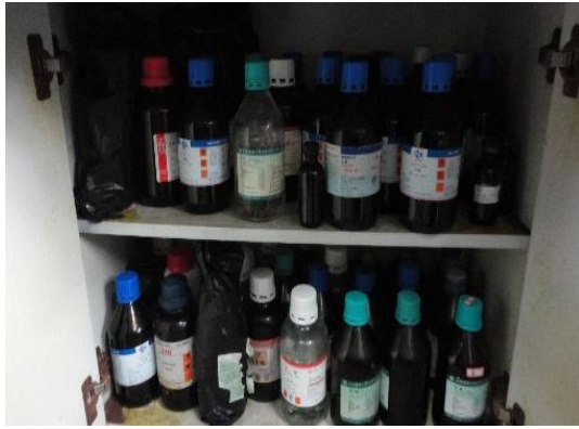
生科楼 C4004—管制类试剂（丙酮、硫酸等） 未放危化品柜
