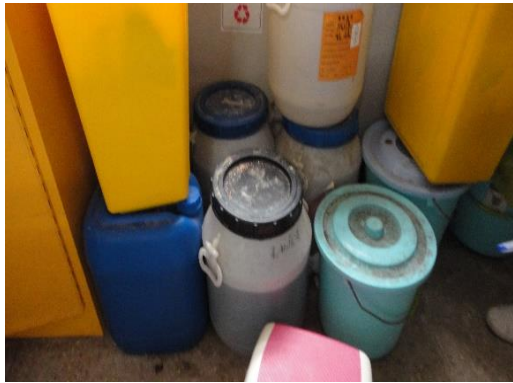
生科楼 C2029—废液装在大口径的桶内， 且没有标识
