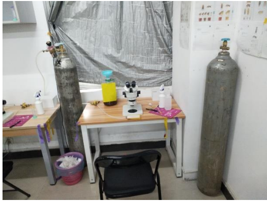
教学楼 E303—气瓶未固定
