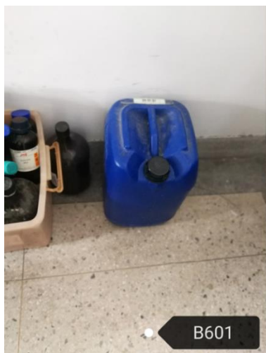
理科楼 B601—废液桶未贴标签，废液未分类；固体实验室废弃物未分类
