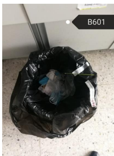
理科楼 B601—废液桶未贴标签，废液未分类；固体实验室废弃物未分类
