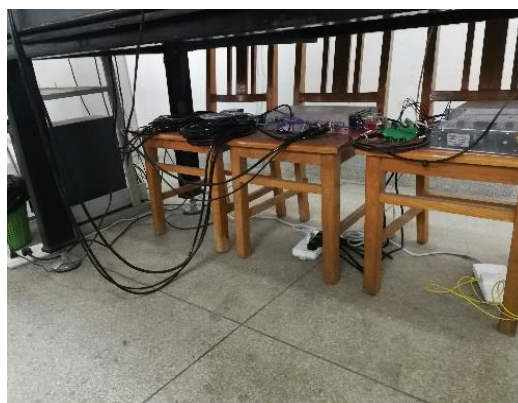
博远楼 A102—接线板串接使用
